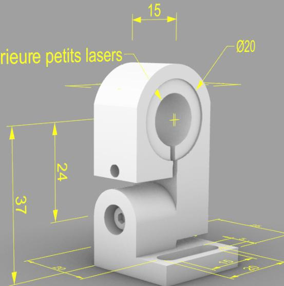
Support de fixation GA-FIX-20 ou GA-FIX-13 suivant le diamètre du laser.
